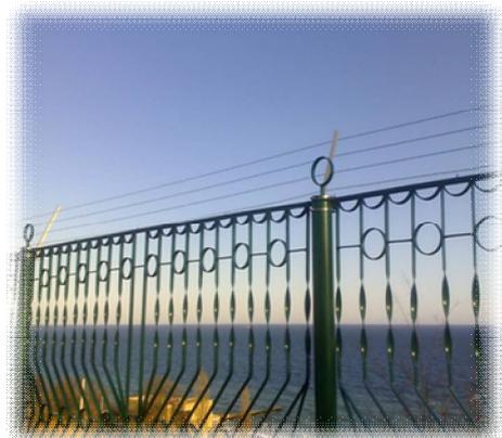
Ниже приведен пример состава оборудования периметра частного дома на длину 120 метров горизонтально установленного забора с электроограждением в виде «козырька» из шести нитей. Установка линейных изолирующих опор через 3.0 метра. Ориентировочная стоимость оборудования и монтажа «под ключ» с годовой гарантией, как правило, не превышает 35 USD за один погонный метр блокируемого периметра.
