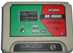
HR-10000 включает в себя два внутренних модуля (управляемых микроконтроллером), которые обеспечивают и отображают режимы работы системы при помощи светодиодов, контролируют электроограждение на обрыв и замыкание на землю, и создают электрошоковое воздействие на нарушителя при его вторжении.
